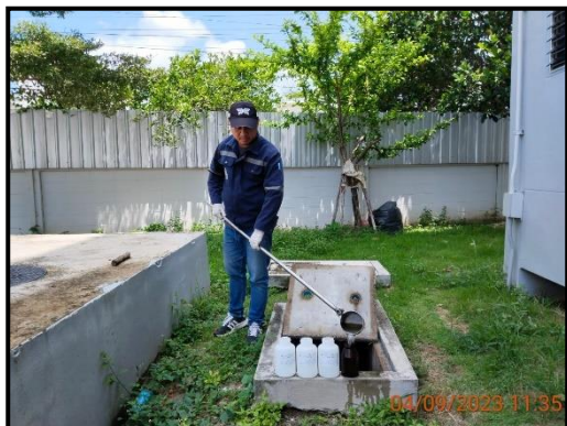
บ่อฟักน้ำทิ้งหลังออกจากระบบบำบัดน้ำเสียรวม
