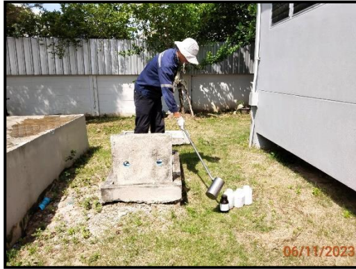
บ่อพักน้ำทิ้งหลังออกจากระบบบำบัดน้ำเสียรวม
